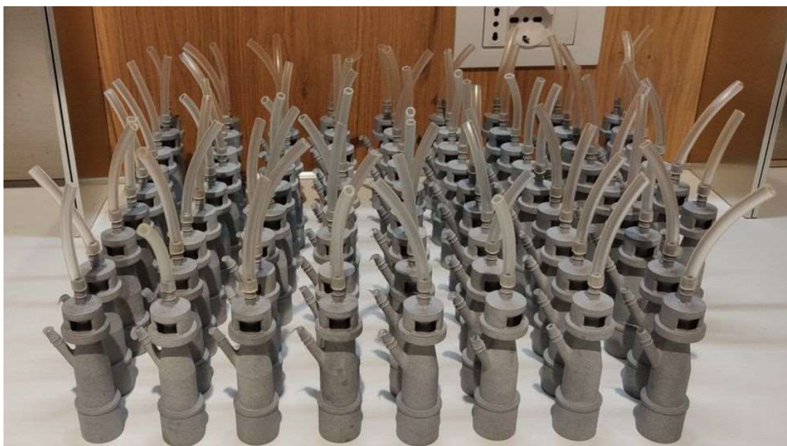
Obr. 1.4-8 Ventily k respirátorům spojující pacienta s dýchacím přístrojem od společnosti ISINNOVA
